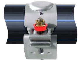
Serrer l'écrou jusqu'à rupture de la partie sécable à l'aide d'un équipement électro-portatif équipé d'une douille de 19 ou à défaut manuellement avec une clé de 19.
